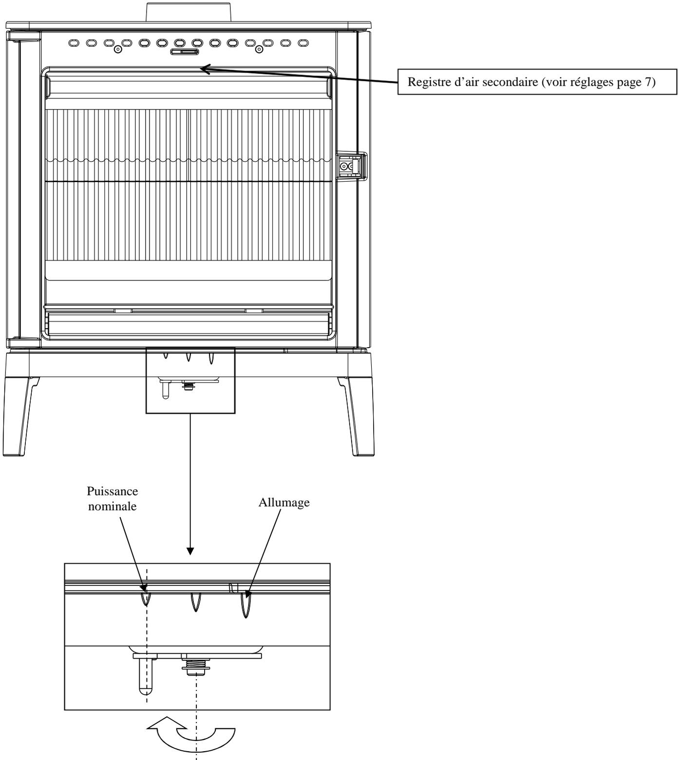
La position « Combustion Prolongée » est obtenue en tournant complètement le registre de réglage vers la gauche (après s'être assuré du maintien en activité de la post combustion)
