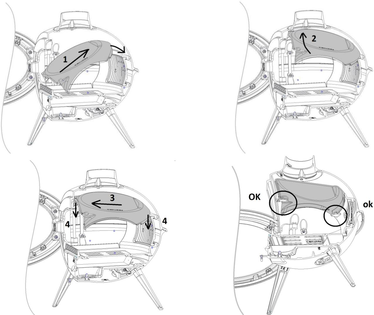
**Inversion Coude raccordement et grille d'entrée d'air :**
